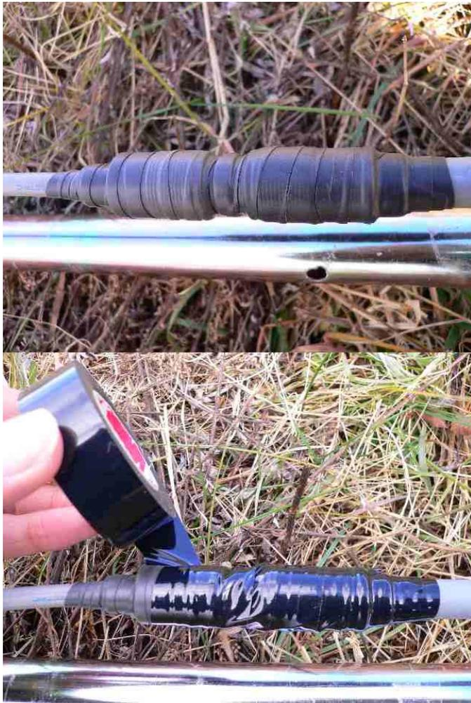
4. 次にバランを取り付けます。先ほど放射器を取り付けたナットの上に重ねるように、バランの圧着端子を接続します。
