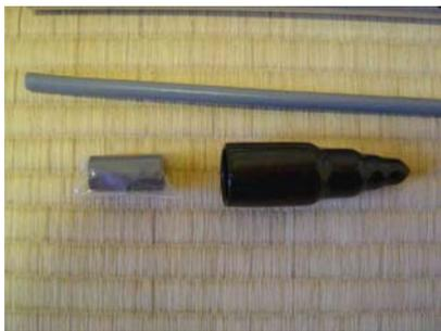
2. フェライトコア(左)と防水カバー(右)。(ちなみにその上は同軸ケーブル)
