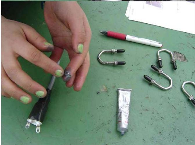
PENETROXを菊座ワッシャとナットの接触面に塗ってからナットを締めます。
