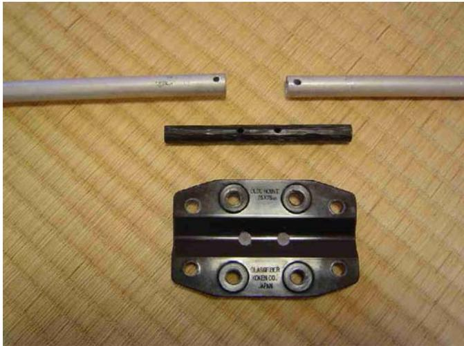
6. クロスマウント: デベマウント25x25mm用(グラスファイバー工研製)放射器をマストに取り付けるもの(ビスの頭が当るので、その部分を自分でえぐって使う)。絶縁物で出来ている必要があるため丈夫なグラスファイバー製を選んだ。ロケットで購入しました。
