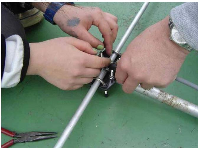
圧着端子、菊座ワッシャ、ナットの順に取り付けます。片方のエレメント部分の図を載せません。クロスマウントとマストの図は省略してありますが、この時点で既に取り付けられています。
