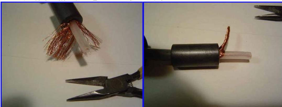
5. 芯線の先端部を10mm剥き、編み組みと芯線を給電部に取付け易いように整形します。
