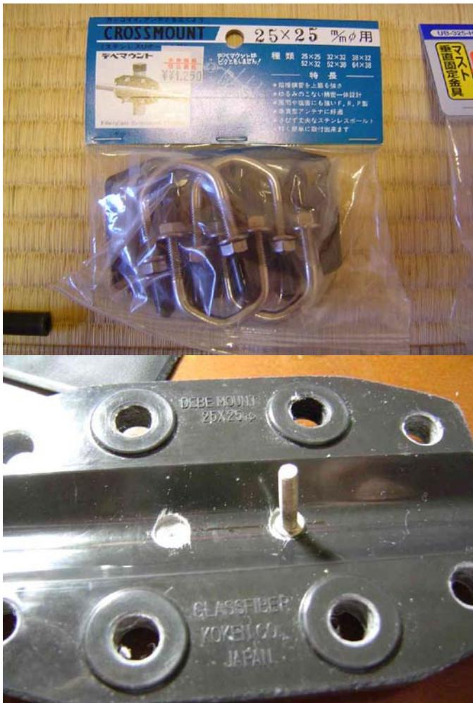
7. ビス(首下25mm長)2本、ナット4個、菊座ワッシャ4個(3mm) ステンレス製。放射器にバランを取り付けるもの。ホームセンター等で購入可。菊座ワッシャは外菊タイプ(右の写真)に変更しました。
