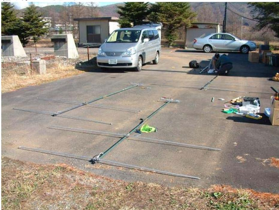
7. 長さ、位置関係を念のためもう一度確認します。反射器が長い方、放射器が短い方です。天頂向きのビームにするため、放射器の方が上側に付きます。間違えるとSWR特性が悪くなったり利得が出ません。
