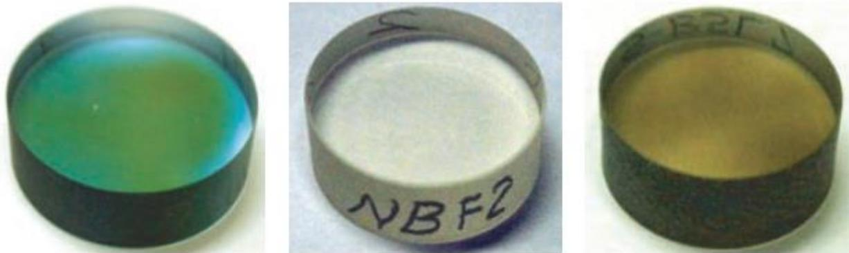
図12：70MeVプロトン照射後のガラス材の着色化の様子
