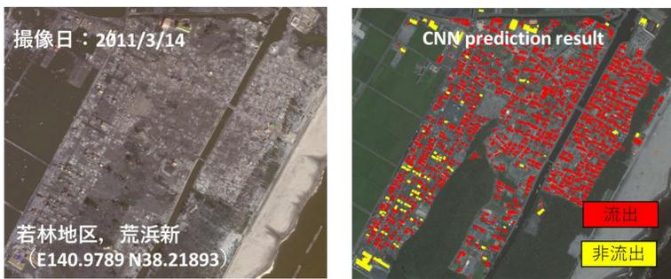
機械学習技術により「被災状況のレベル」を計測 = 従来人間が行っていた「どんなことが起きたか」の判断をAIで自動化できるようになる。
